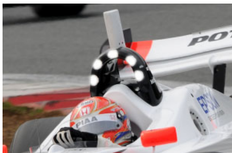
ロールオーバーに取り付けられたオーバーテイクランプは世界初のアイデアだ
